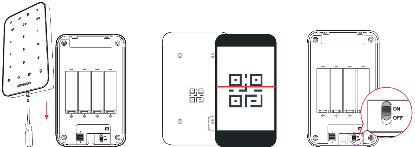
Открутите винт в нижней части клавиатуры. Разберите клавиатуру и снимите заднюю панель.
